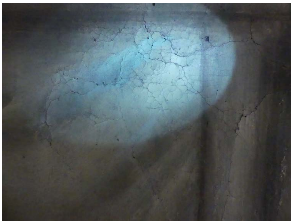
Même détail vu en fluorescence U.V : on voit ici les deux interventions de retouche superposées, la plus récente fluoresçant en bleu
