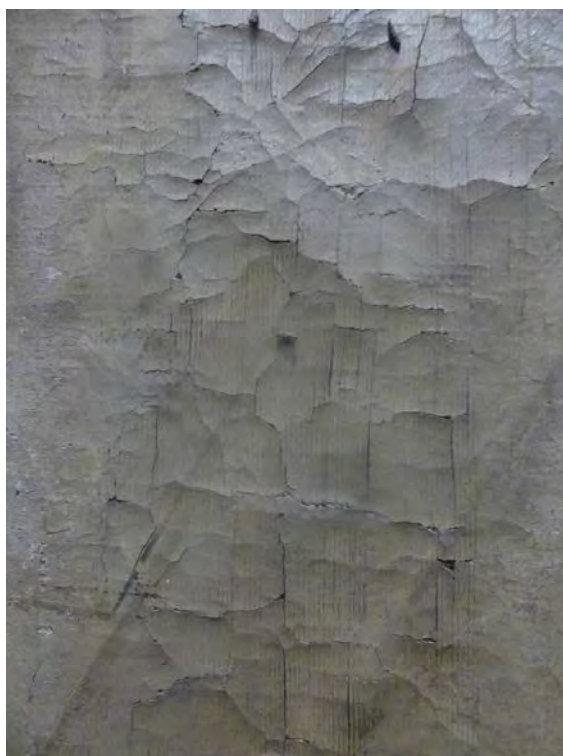
Détail de la grande zone de mastic griffé en soulèvement masquant probablement une incrustation ( première intervention )
