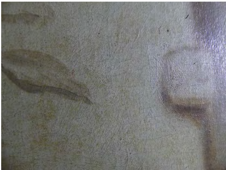
Détail en vue rapprochée montrant le vernis oxydé très irrégulier sur la matière
